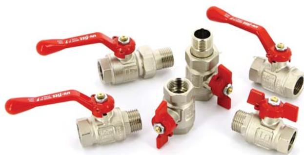
Размерный ряд полнопроходных кранов Uni-Fitt ETALON представлен диаметрами от 1/2" до 2", включая шаровые краны с внутренней, наружной и внутренней резьбой, а также краны с разъемным (муфтовым) соединением («американка»). Последний имеет конусное уплотнение с прокладкой O-Ring для обеспечения надежного и герметичного соединения. Такой вид крана позволяет подключать к системе устройства, требующие периодической профилактики.
